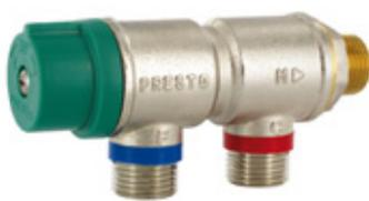
Régulateur thermostatique entrée parallèle 1/2", mitigeur centralisé pour distribution d'eau mitigée, butée de température, filtres et clapets anti retour NF. Débit de 43 L/min. à 3 bar
